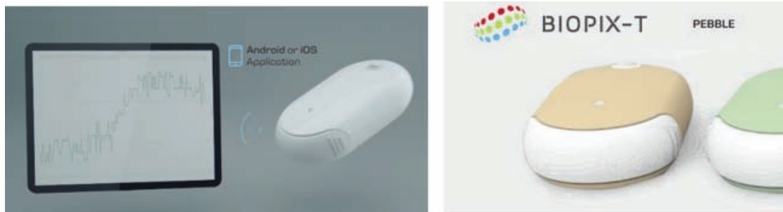
Instrumentation portable de dépistage de pathogènes par analyse de leurs acides nucléiques (Développé par l'Université de Crète)
